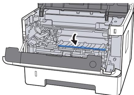
**12 Vrat'te jednotku válce do původní polohy.**
